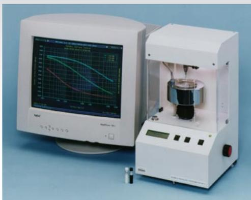
Многие химические и физические процессы, имеющие в своем составе поверхностно-активные компоненты, очень скоротечны. Распыление, печать и смачивание – это динамические процессы; в процессе измерения поверхностное натяжение может значительно меняться за десятые доли секунды.
