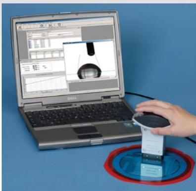
MobileDrop – новое достижение в технологии измерения краевого угла; этот прибор позволяет определять смачиваемость поверхности и рассчитывать свободную энергию поверхности (СЭП). Идеально подходит для контроля качества поверхностей.
